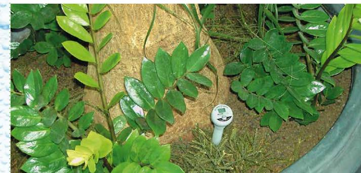
**ATTENZIONE:** controllare sempre il livello dell'acqua nel tubetto quando è molto bagnato. Nel caso che il livellasi sia abbassato riempire con acqua fino al bordo.
